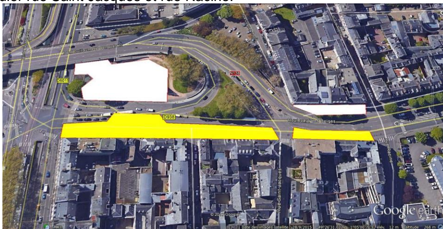
En jaune les emprises impactant la circulation ; en blanc celles sans impact.
